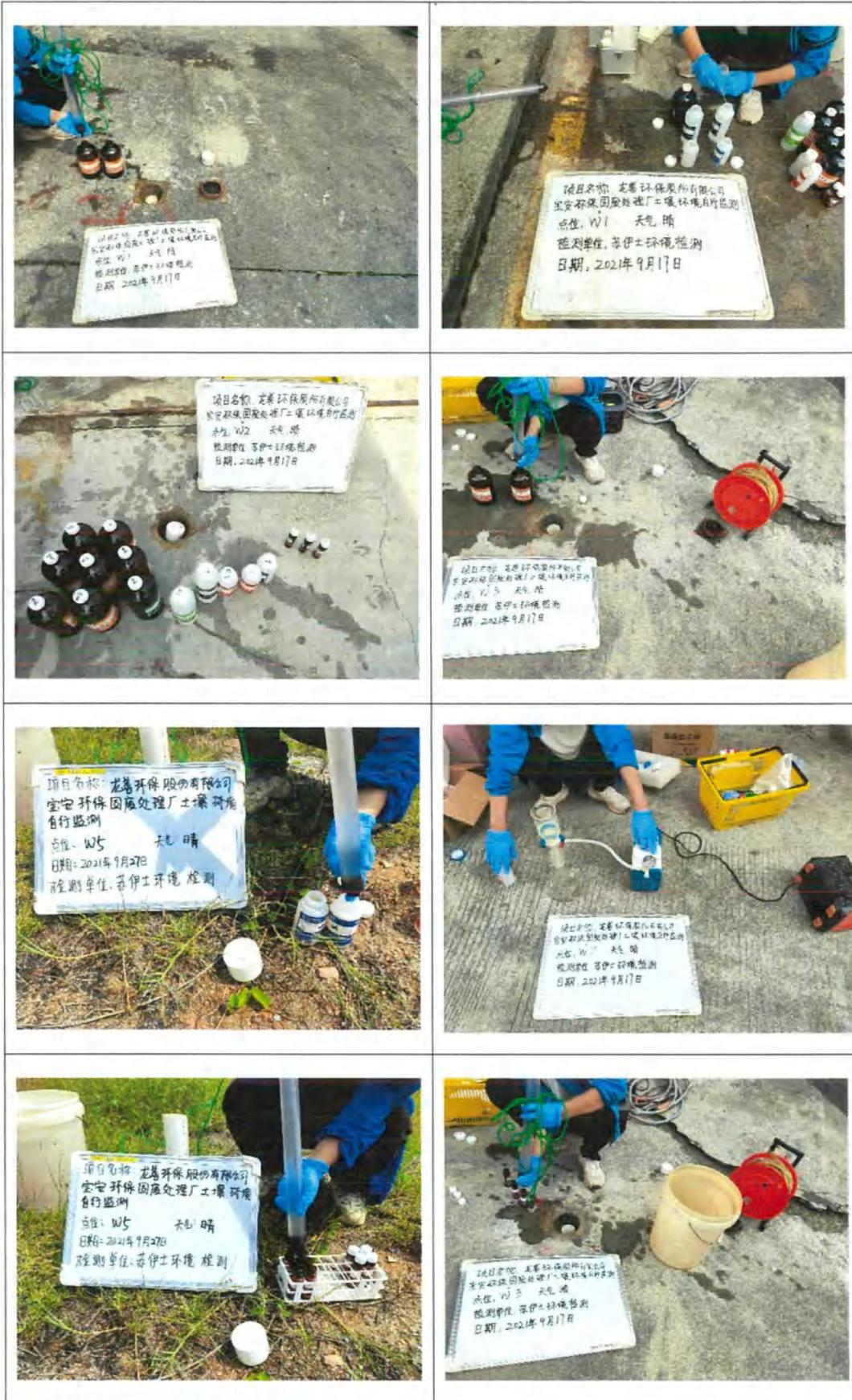
图 2.5-4 地下水样品采集照片
