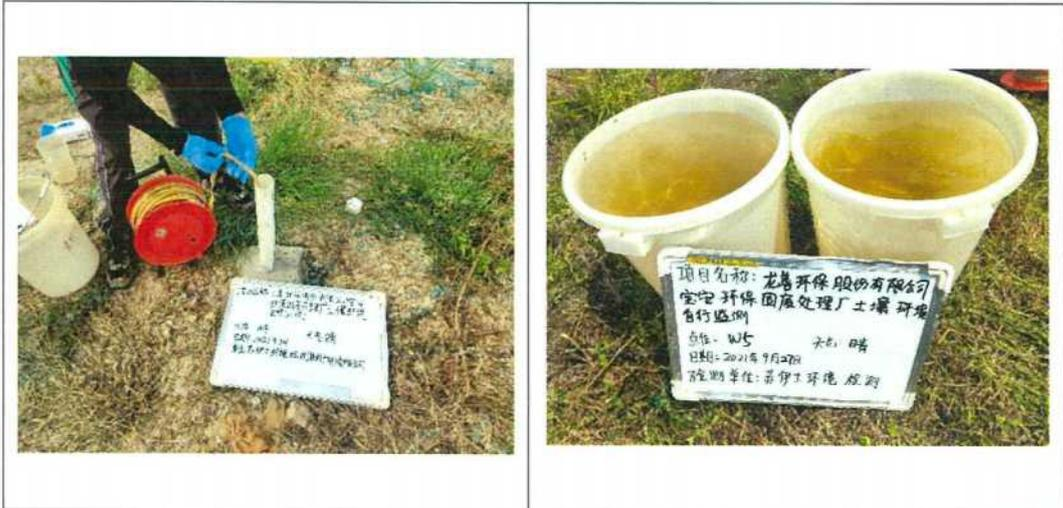
图 2.5-3 地下水洗井照片
