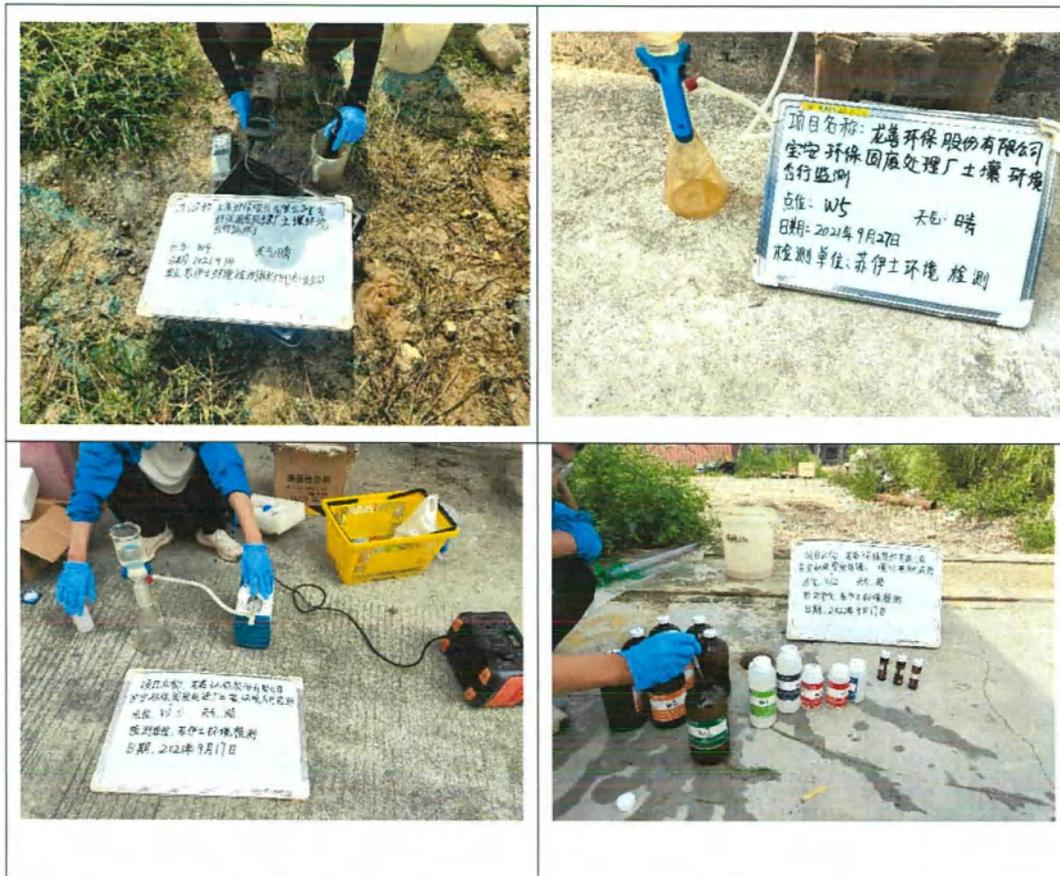
图 2.5-5 金属样品过滤&现场水质参数测定照片
